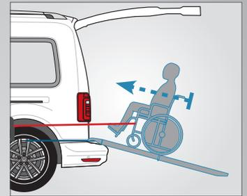
**Möglichkeit zur Installation der Seilwinde „F-Winch“** welche ein leichtes Ein- und Ausladen des Rollstuhls ermöglicht.
